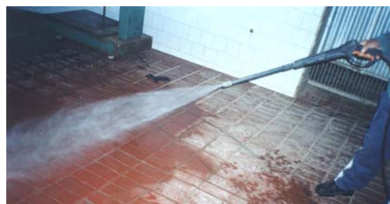
Figura 2 – Equipo de limpieza de la planta (se observa la manguera y la pistola ahorradora de cierre automático)
