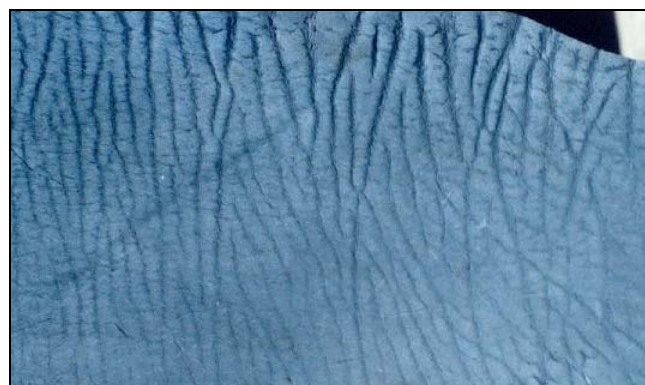
Figura 3 - Wet blue obtenido antes de implementar la recomendación (descarnado antes del pelambre).
