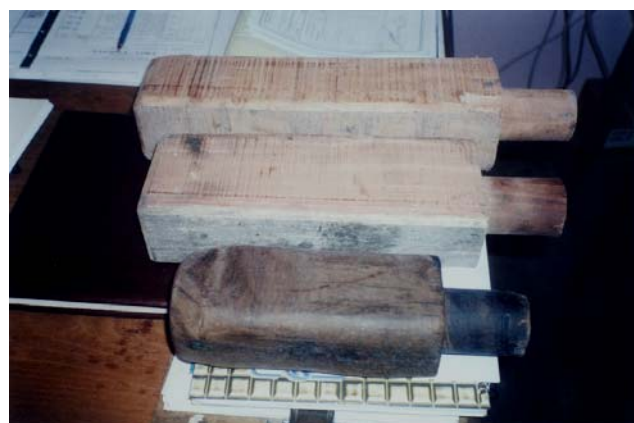
Figura 13 - Tarugo original utilizado en diferentes tamaños de fulones (abajo) y tarugos modificados según las dimensiones de los fulones (al medio y arriba).
