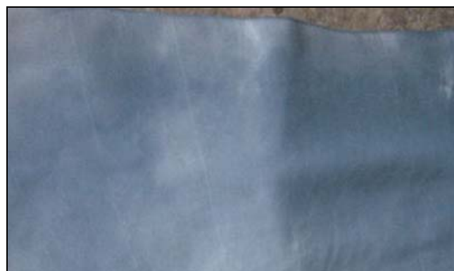
Figura 4 - Wet blue obtenido después de implementar la recomendación (descarnado antes del pelambre).
