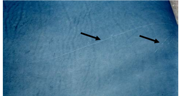
Figura 7 - Rayas en una pieza de wet blue causadas por piedras y material calcáreo contenidos en una cal de mala calidad.
