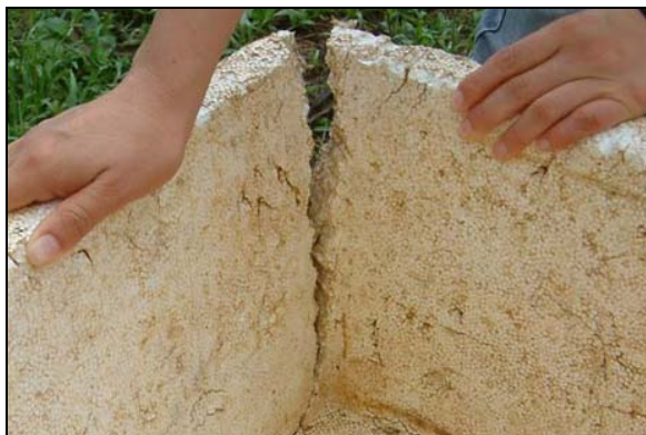
Figura 1 Caja de termo con fisura en la esquina
