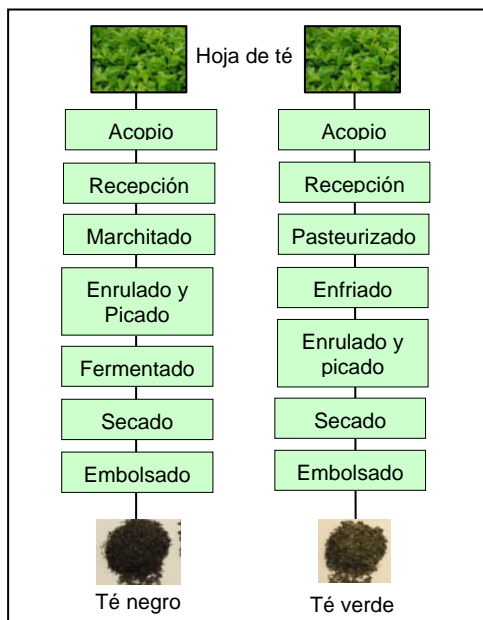
Figura 1 Diagrama de flujo para la obtención de té negro y verde.
