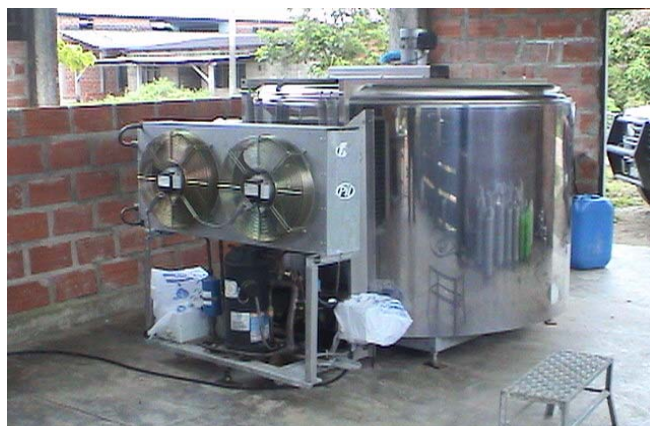
Figura 12. Tanque de enfriamiento en Cruce Chancadora (1,500 L)
