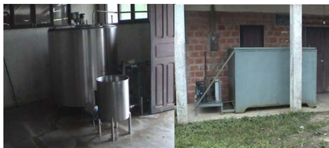
Figura 14 Tanque de enfriamiento y banco de agua helada en Bulu Bulu (1,300 L)
