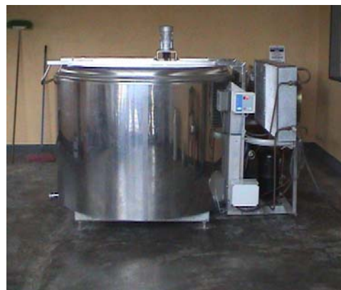
Figura 13 Tanque de enfriamiento en 23 de Marzo (1,250 L)
