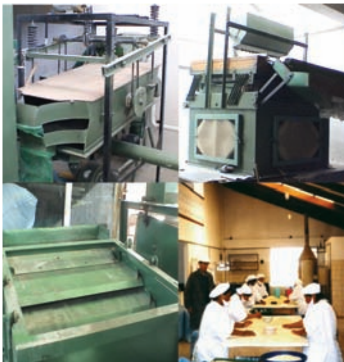
Figura 6. Clasificador granulométrico (izquierda superior), despedregador densimétrico (derecha superior), despajador, en desuso (izquierda inferior); y operación de pallado (derecha inferior).
