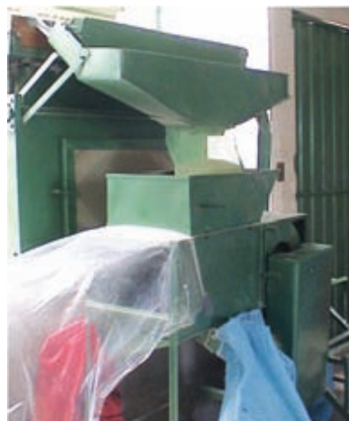
Figura 7. Venteador manual, al que se le adaptó un motor eléctrico, que es utilizado para reducir el contenido de paja del grano que sale del despedregador.
