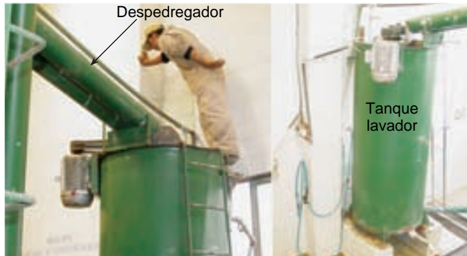
Figura 3. Despedregador (izquierda), conformado por dos tubos con reparos interiores; y lavador (derecha), conformado por un tanque (capacidad = 1.6 m 3 ) para procesar lotes de 430 kg de grano de quinua.
