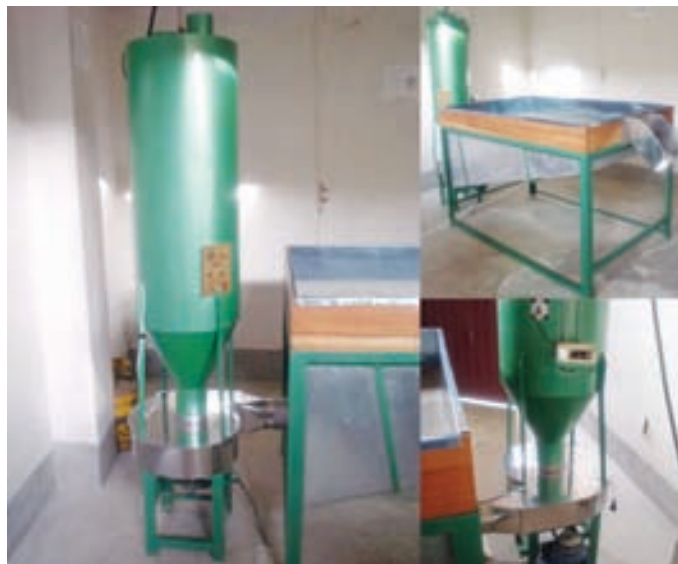
Figura 5. Sistema de secado: generador de aire caliente (izquierda), mesa de secado (derecha superior) y turbina de alta eficiencia (derecha inferior), que opera con un motor de 2 hp.
