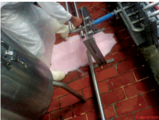
Figura 2 Descarga de las pérdidas de yogurt que quedaban en un tanque
