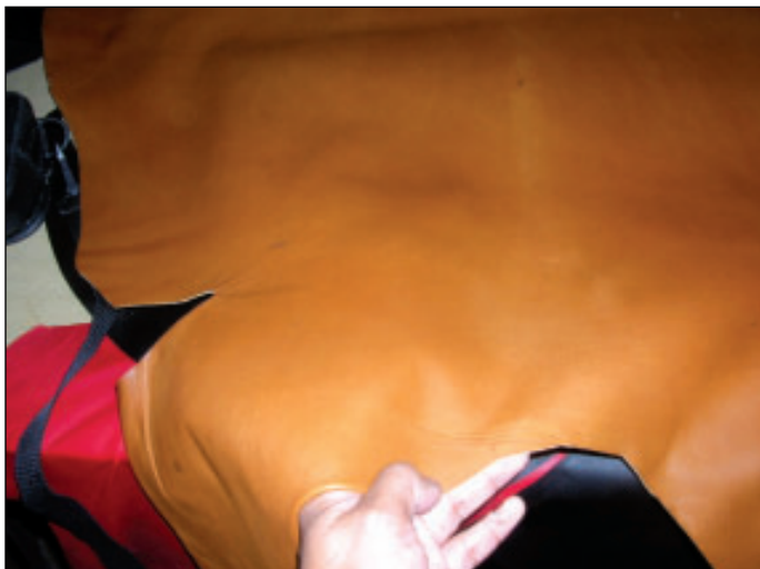
Figura 7 Cuero acabado después de implementar medidas de PML. Puede observarse un cuero con flor lisa, sin manchas o arrugas y teñido más uniforme. En resumen, un cuero de mayor calidad.
