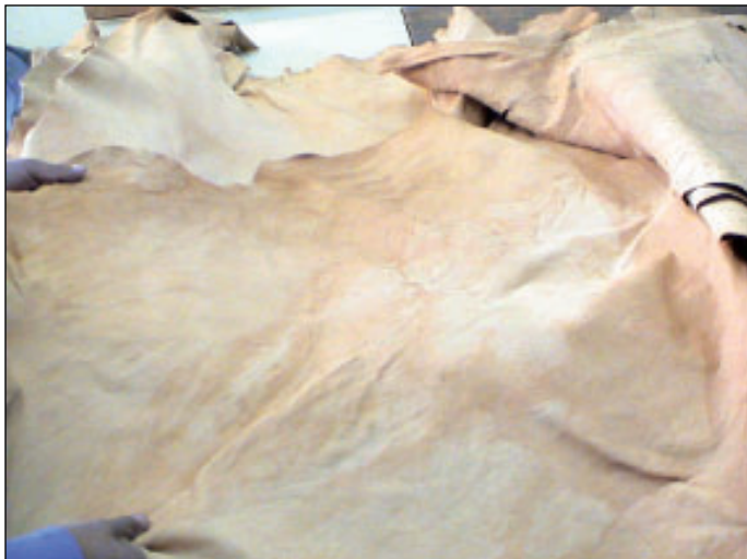
Figura 6 Cuero acabado antes de implementar medidas de PML. Puede observarse arrugas, manchas, material no homogéneo y apariencia acartonada.
