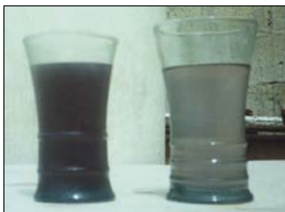
Figura 10 - Licor de curtido al cromo a reciclar (izquierda) y licor de curtido al cromo reciclado (derecha).
