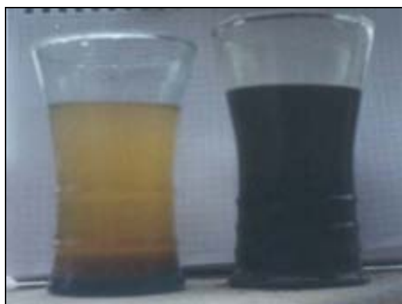
Figura 11 - Licor de curtido al tanino a reciclar (derecha) y licor de curtido al tanino reciclado (izquierda).
