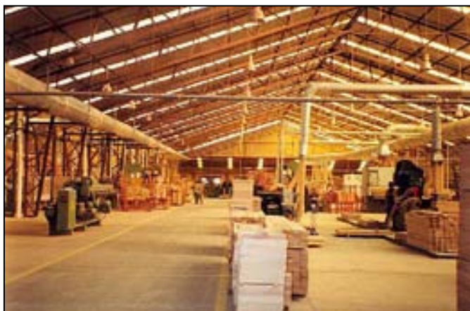
Figura 3 La misma área de trabajo en mayo de 2003, con el sistema centralizado de extracción de polvo funcionando
