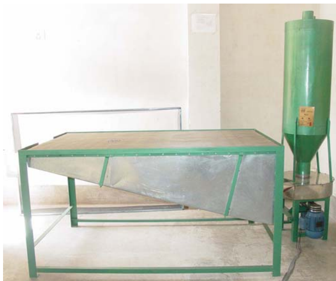
Figura 3. Generador de aire caliente y mesa de secado.
