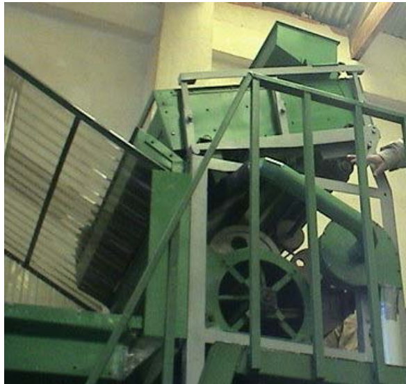
Figura 1. Clasificador y venteador de grano.
